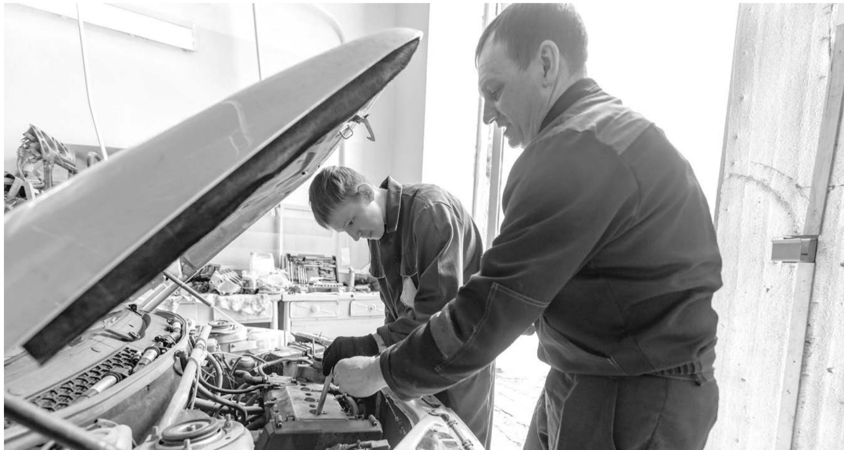
Будущий мастер по ремонту и обслуживанию автомобилей Никита Гордиенко выполняет диагностику двигателя автомобиля – проверяет компрессию в цилиндрах. Процессом руководит мастер производственного обучения Александр Прыгунов
