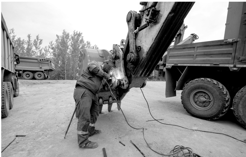
Стопорный палец на ковше экскаватора починили быстро
